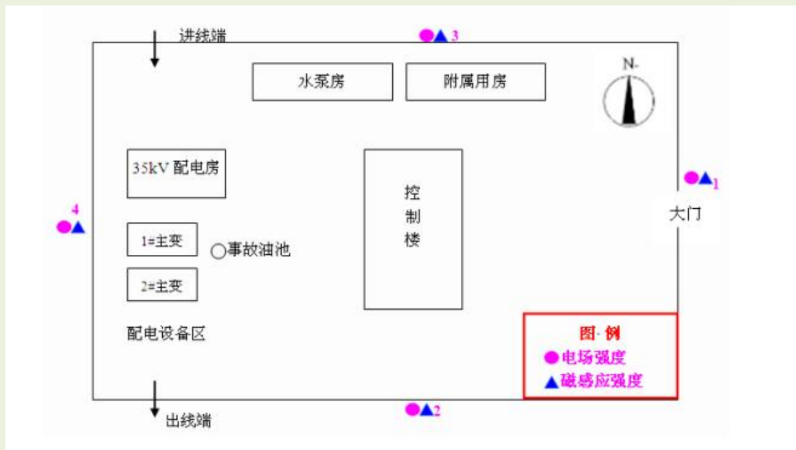
图 1.6-1 类比苏宝顶风电场 110kV 升压站电磁环境监测布点示意图
